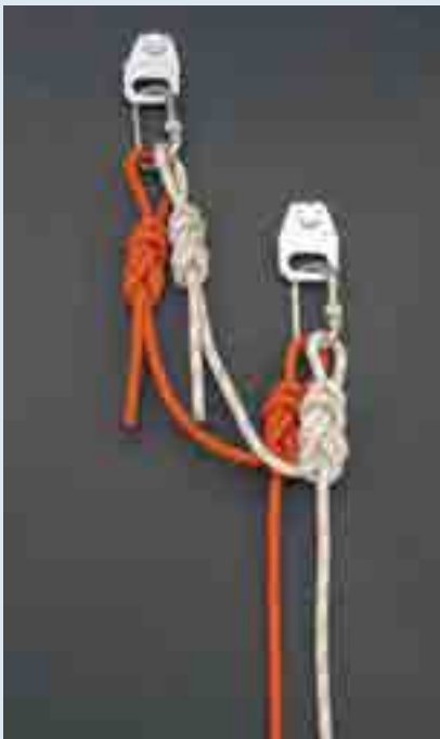
Figure 4. Ancrage des cordes de travail et de sécurité.
