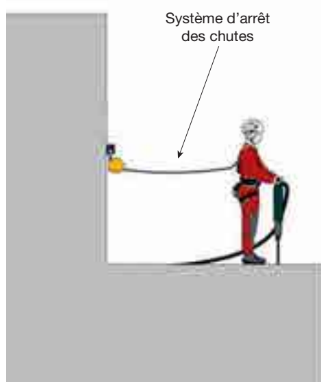
Figure 3. Exemples de cas où un ouvrier en hauteur est ou n'est pas en situation de cordiste (Source : OPPBTP, Travaux sur cordes , 2010).
